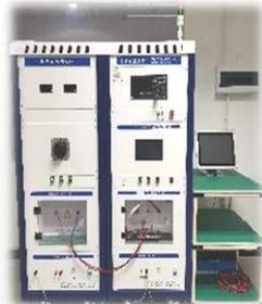
雷击浪涌电流测试仪
