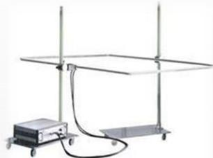
工频磁场抗扰度测试天线
